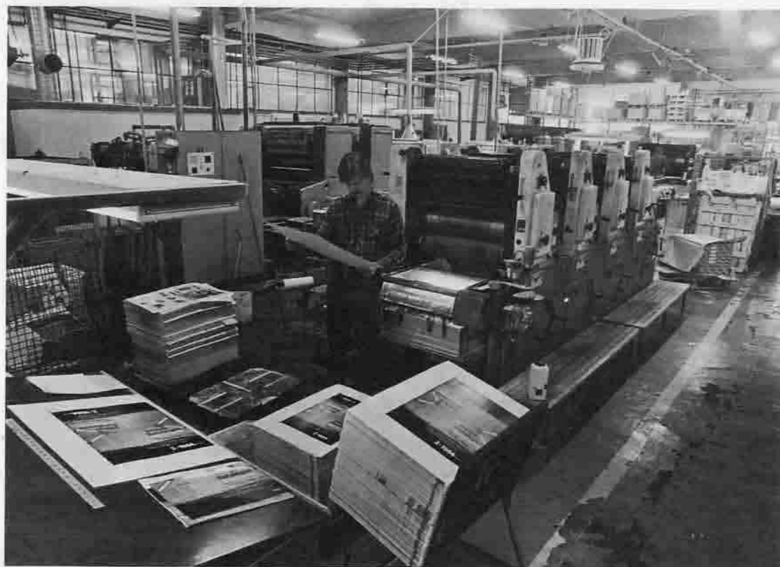
C. Från tryckhallen med en fyrfärgspress i förgrunden. I den trycks alla fyra färgerna på en gång.
