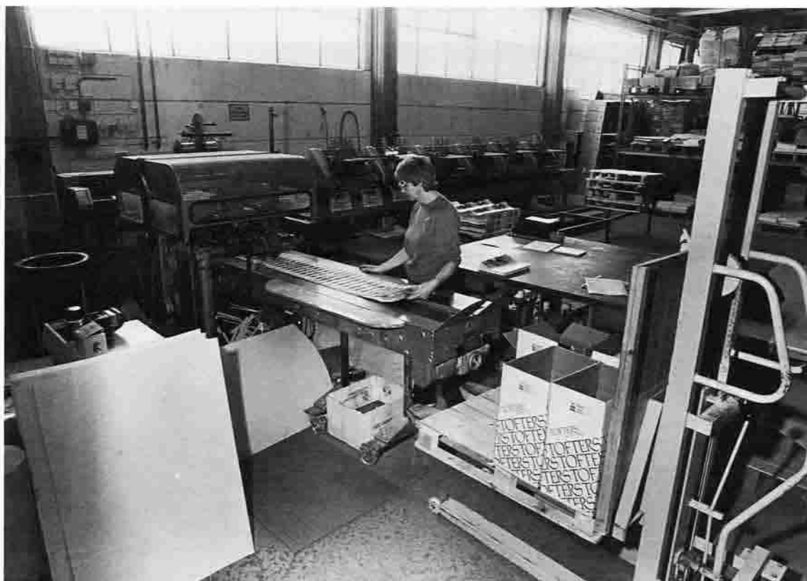
D. Efter tryckningen falsas, häftas och skäres tidningarna. I maskinen kan flera ark läggas upp i de olika stationerna.
