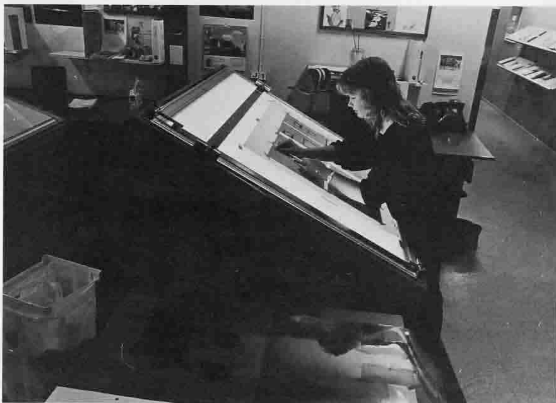
B. Sidfilmerna monteras manuellt till ark. Dessa kopieras sedan på plåtar som inspänns i tryckpressarna.
